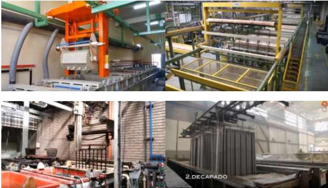
Imagen 3.- Ejemplos de líneas de galvanizado (Fuente: [4], [5], [6], [7])
